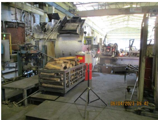
รูปที่ 4-49 แสดงการตรวจวัดระดับความร้อนในการทำงาน รางส่งน้ำทองแดง 2 (คุณณัฐนันท์ คำสุข) ตรวจวัดในวันที่ 6 เมษายน 2566
