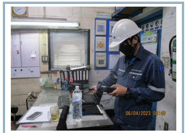
รูปที่ 4-45 แสดงการตรวจวัดความเข้มข้นของแสงสว่าง ห้องควบคุม Furnace โต๊ะทำงานคุณคุณณัฐนนท์ คำสุข ตรวจวัดในวันที่ 6 เมษายน 2566
