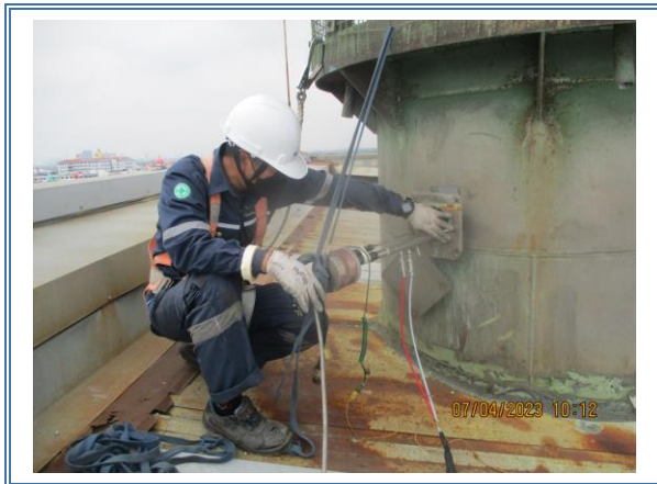
รูปที่ 4-34 แสดงการตรวจวัดปริมาณสารเจือปนในอากาศ ที่ระบายออกจากปล่องระบายเตาหลอม เก็บตัวอย่างในวันที่ 7 เมษายน 2566
