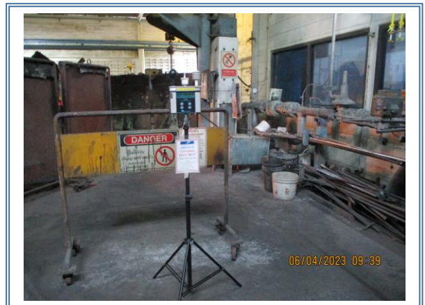
รูปที่ 4-48 แสดงการตรวจวัดระดับความร้อนในการทำงาน รางส่งน้ำทองแดง 1 (คุณเกษม หอมกลิ่นคล้าย) ตรวจวัดในวันที่ 6 เมษายน 2566
