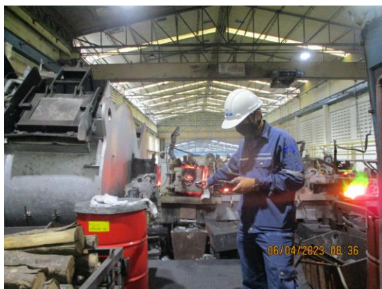
รูปที่ 4-42 แสดงการตรวจวัดความเข้มข้นของแสงสว่าง บริเวณรางส่งน้ำทองแดง 2 (คุณณัฐนันท์ คำสุข) ตรวจวัดในวันที่ 6 เมษายน 2566
